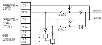
每个 DB 口都含有 2 芯电源线，用于向 PLC 模块供电。
