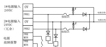
每个 DB 口都含有 4 芯电源线，用于向 PLC 模块供电。这些电源由电源输出设置的短路帽进行控制。
